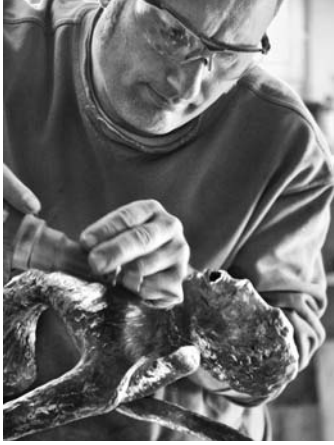
Schweissnähte und Anschnittstellen werden verarbeitet und ziseliert.
